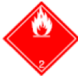
Label 2.1: flammable gas.
